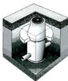
図 ハットリング工法の施工状況
